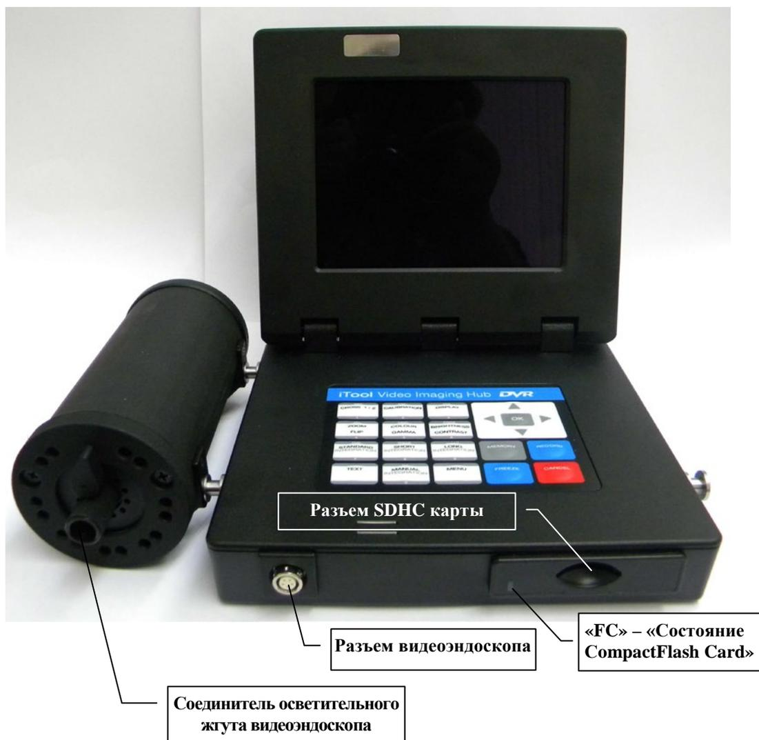
Рисунок 1.1 K-Visio Pro-5 в сборе с осветителем – вид спереди
