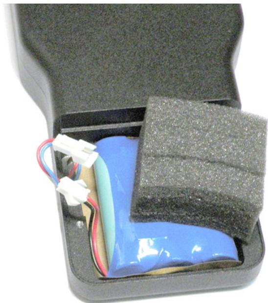
Рис. 1-5. Установка нового аккумулятора
