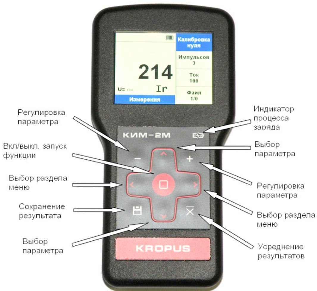
Рис. 1-7. Клавиатура коэрцитиметра
