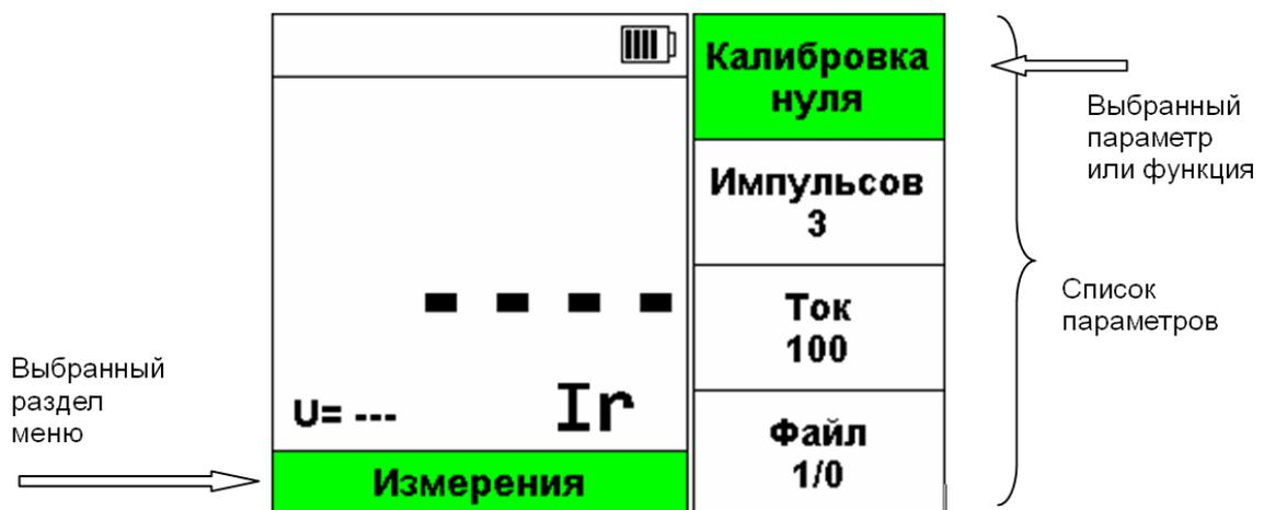
Рис. 1-9. Меню коэрцитиметра (вид экрана прибора).
