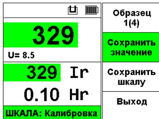
Рис. 4-9. Результат измерения сохранен в базовое значение образца
