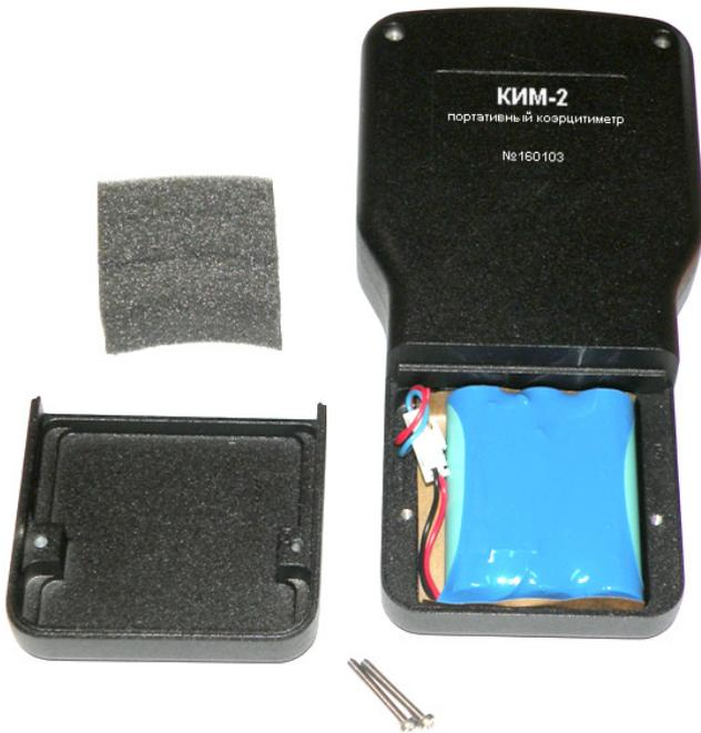
*Рис. 1-3. Прибор со снятой крышкой аккумуляторного отсека*
