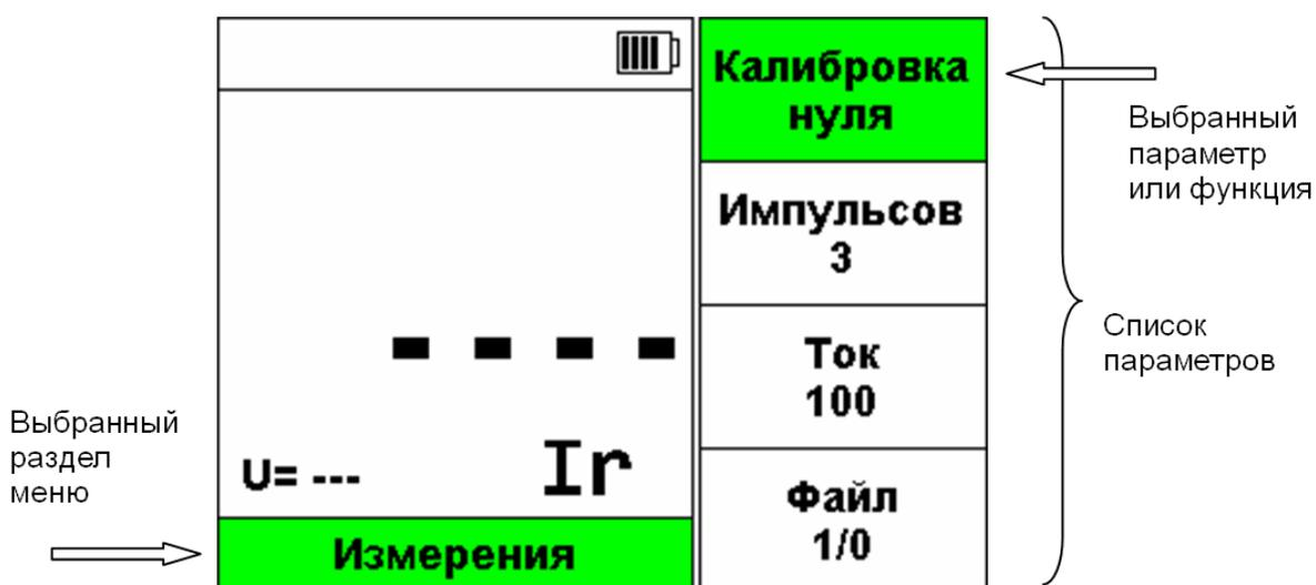
Рис. 2-1. Экран коэрцитиметра
