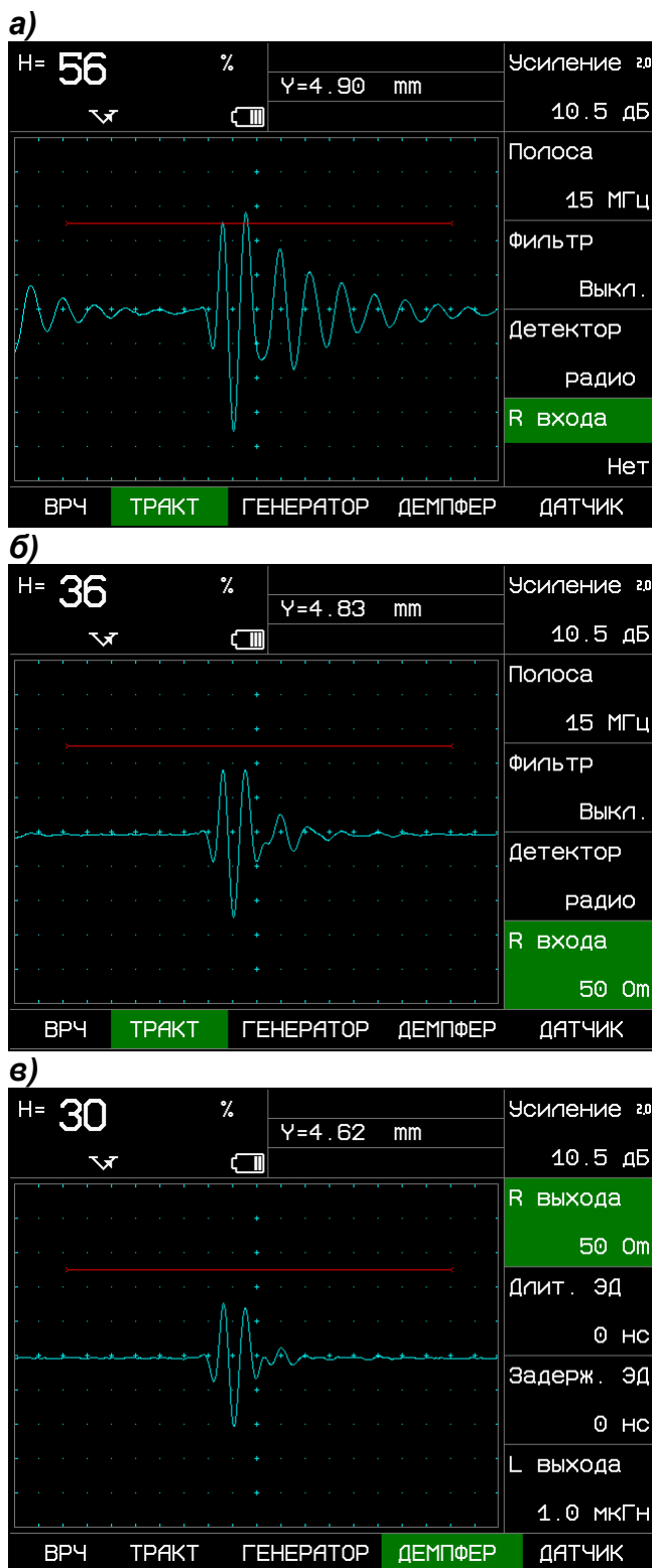
Рис 2-6 Результат применения демпфирования на несогласованном датчике 5МГц
